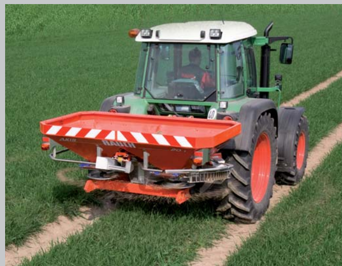
AXIS 20.1, 12 – 36 м, 2100 кг макс. загрузки
