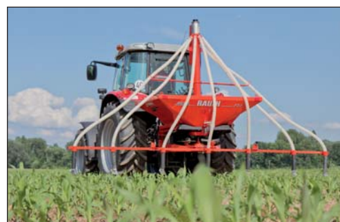
RFZ-7: оборудование для рядового внесения удобрений для овощей и пропашных культур.
