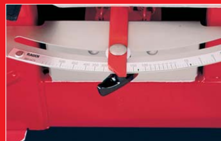
Пропорциональная DfC-шкала установки нормы внесения удобрений для левой и правой стороны отдельно для вариантов K и R.
