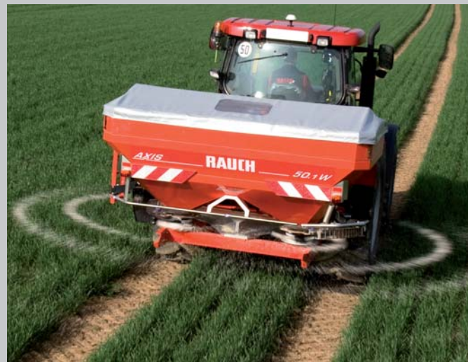
AXIS 50.1, 12 – 50 м, 4000 кг макс. загрузки
