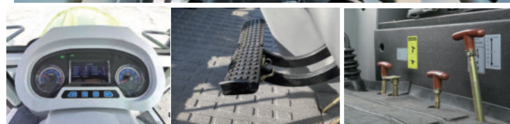
Многофункциональная приборная панель. Тормоз включает в себя механическое устройство синхронизации. Блокировка дифференциала / полный привод / рычаг управления ВОМ.
